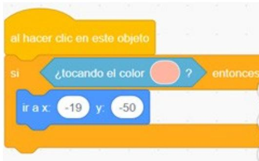
Dentro del condicional “si” está el sensor que permitirá saber qué color del fondo está tocando tu objeto. Si observas con cuidado la imagen del fondo, notarás que para cada parte hay una zona con un color distinto. Al dar clic en el color de tu sensor, se abrirá una nueva ventana para cambiar los colores. Utiliza la opción del gotero, y aparecerá una lupa. Selecciona el color de la parte de la célula que corresponda.
