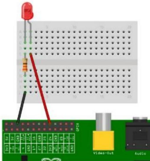
Es muy importante conectar los componentes de forma correcta para evitar todo tipo de problemas. El ánodo del LED (la patita larga) se conecta al pin GPIO 24 de la RPi, mientras que el cátodo (la patita corta) se conecta a la resistencia. El otro extremo de la resistencia se conecta a tierra (cualquiera de los pines GND de la RPi). La siguiente figura, muestra cómo se ven los componentes ya conectados:
