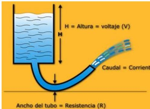
Un aumento del Voltaje (mayor altura de agua) o disminución de la Resistencia (tubo más ancho), provoca un aumentando proporcional de la Corriente eléctrica (mayor caudal de agua).
