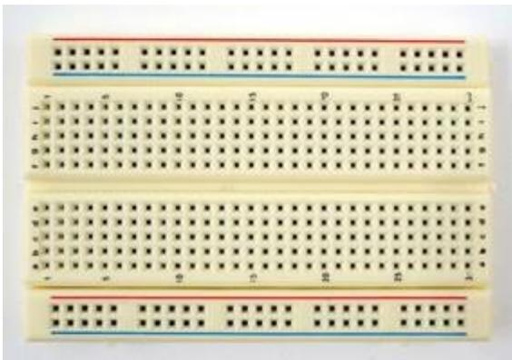
Un Protoboard es una placa para experimentación de circuitos electrónicos, en los que se pueden insertar o pinchar elementos electrónicos y cables con los que se armar circuitos de prototipado sin la necesidad de soldar ninguno de los componentes.
