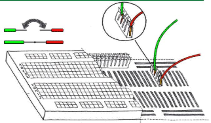
Las Protoboards tienen tres partes: el canal central, las pistas, y los buses. En el canal central, ubicado en la parte media, se conectan los circuitos integrados para mantener aislados los pines de ambos lados del circuito integrado. Los buses se encuentran en los lados de la
